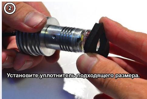
Установите уплотнитель подходящего размера.
