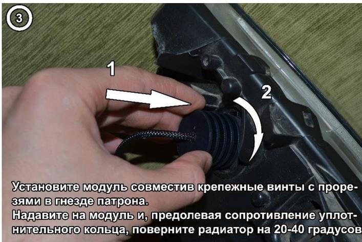
Установите модуль совместив крепежные винты с прорезями в гнезде патрона. Надавите на модуль и, преодолевая сопротивление уплотнительного кольца, поверните радиатор на 20-40 градусов.
