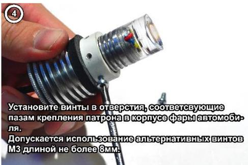
Установите винты в отверстия, соответствующие пазам крепления патрона в корпусе фары автомобиля. Допускается использование альтернативных винтов М3 длиной не более 8мм.
