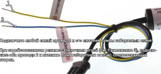
Подключите любой синий провод 2 к «+» питания лампы габаритных огней.
