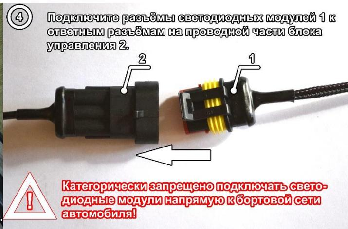
Подключите разъёмы светодиодных модулей 1 к ответным разъёмам на проводной части блока управления 2.
