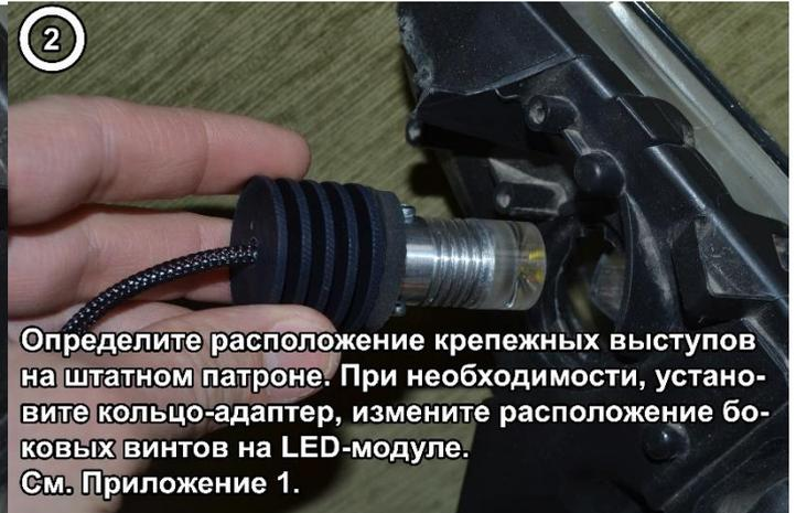
Определите расположение крепежных выступов на штатном патроне. При необходимости, установите кольцо-адаптер, измените расположение боковых винтов на LED-модуле. См. Приложение 1.
