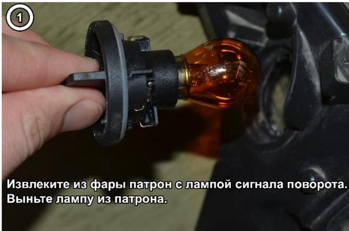
Извлеките из фары патрон с лампой сигнала поворота. Выньте лампу из патрона.
