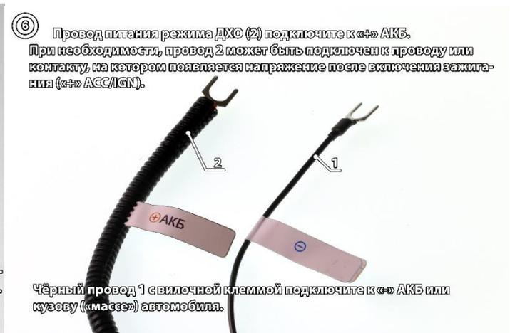
Провод питания режима ДХО (2) подключите к «+» АКБ. При необходимости, провод 2 может быть подключен к проводу или контакту, на котором появляется напряжение после включения зажигания («+» ACC/IGN).
